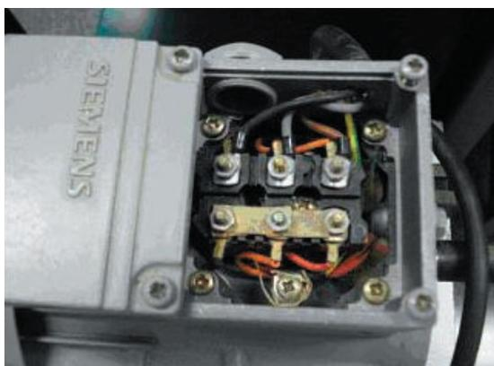
Fig.277. Motor conectado en estrella.
