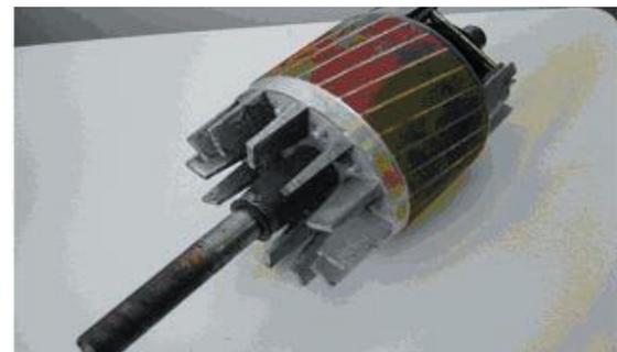
Fig.275.Rotor de un motor asíncrono.
