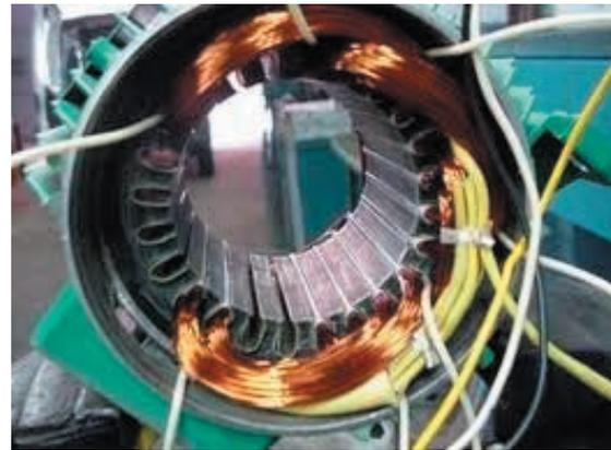
Fig.274.Estator de un motor asíncrono.
