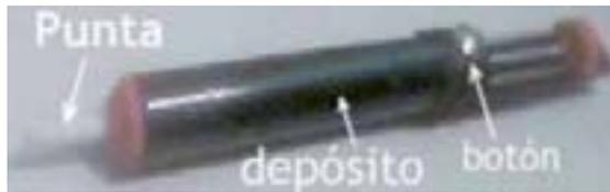
Este desoldador de vacío es una bomba de succión que consta de un cilindro que tiene en su interior un émbolo accionado por un muelle.
