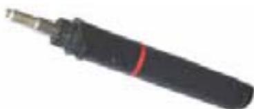
El uso más común que se les da a estos soldadores en electrónica es el de soldar y desoldar pequeños circuitos integrados, resistencias, condensadores y bobinas SMD.
