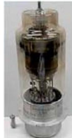
*Tiratrón de hidrógeno de General Electric, utilizado en radares.*
