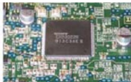
Repetimos este procedimiento en los cuatro lados del integrado asegurándonos de que se calientan las patas cerca de las que va a pasar el alambre de cobre para separarlas de los pads (islas).
