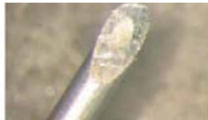
Esta sustancia química, al fundirse junto con el estaño, facilita que éste se adhiera a las partes metálicas que se van a soldar.
