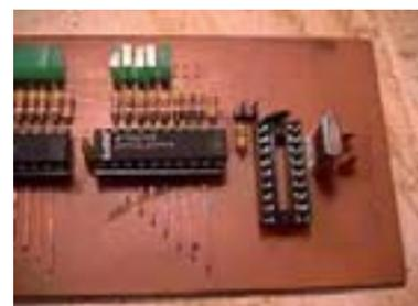
Debe calentarse cada pata del integrado con el soldador de punta fina, comprobando que el estaño se funda entre las partes a unir.
