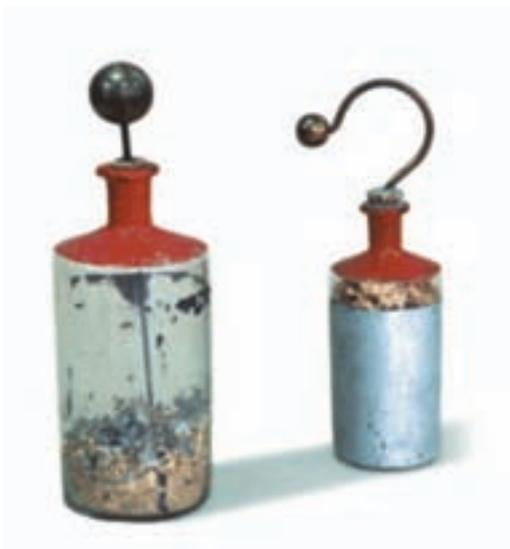
Una vez cargada, si se ponen las dos armaduras en contacto, mediante un conductor, se descargará con una chispa y una pequeña explosión.
