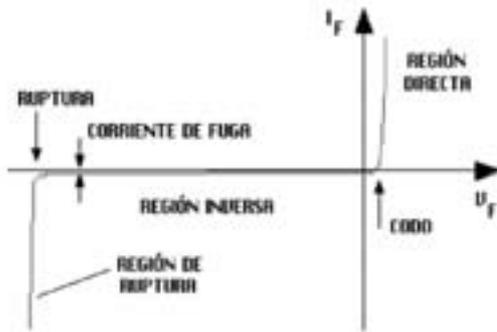
Curva característica típica de un diodo.
