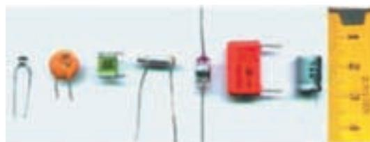
Fig. 1: Diversos tipos de condensadores.
