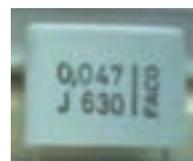
*Ejemplo: un condensador marcado con 0,047 J 630 tiene un valor de 47000 pF = 47 nF, tolerancia del 5% sobre dicho valor y tensión máxima de trabajo de 630 v. También se podría haber marcado de las siguientes maneras: 4,7n J 630, o 4n7 J 630.*
