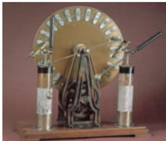
Se trata del generador de Wimshurt y es un dispositivo cuyo funcionamiento se basa en la electrización por frotamiento, contacto e inducción.
