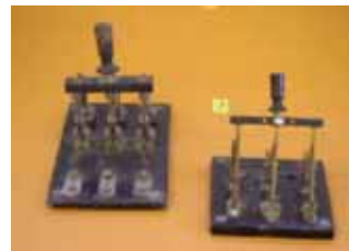
Antiguos interruptores de cuchillas.
