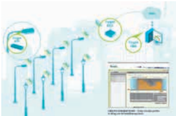
Fig. 32. Sistema de control centralizado de alumbrado público (T-LIGHT, 2015).
