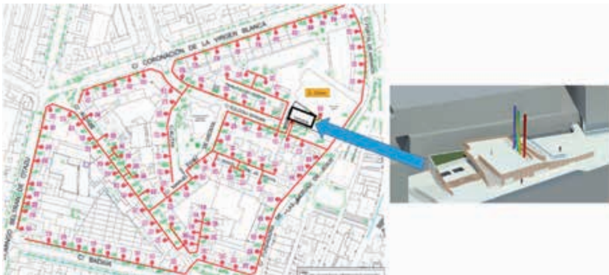
Fig. 12. Sistema de calefacción de barrio en Vitoria (VITORIA-GASTEIZ, 2016).
