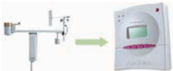
Fig. 17. Medida de magnitudes climatológicas para la estimación de la evapotranspiración de referencia (MEZA, 2015).
