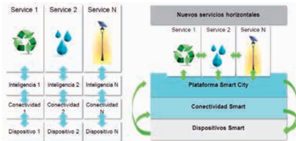
Fig. 10. Estructura de servicio aislados clásicos vs. servicios horizontales de una Smart City (SANTANDER, 2012)
