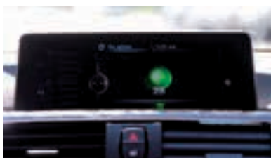
Fig. 44. Sistema Enlighten para conocer la temporización de los semáforos (SIGNALS, 2016).
