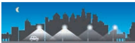
Fig. 30. Ajuste del nivel de iluminación, basado en la detección de la velocidad y sentido del desplazamiento (OWLET, 2013).
