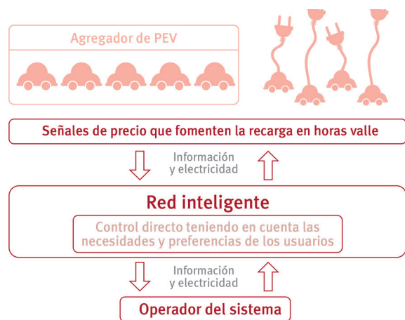
Fig. 1.20. Sistemas de coincidencia red eléctrica-vehículo enchufable. (Fuente: REE)
