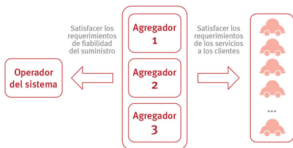
Fig. 1.21. Intermediario entre el operador eléctrico – recargadores de vehículo eléctrico enchufable.
