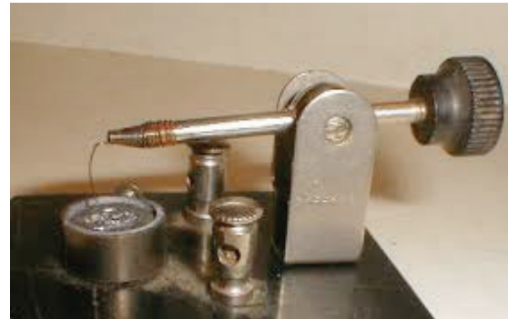
Fig.398 Detector de galena o germanio, como así se llamó.
