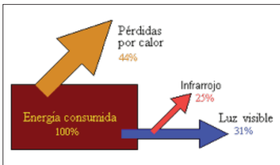
Fig.380 Balance energético de una lámpara de vapor de sodio a baja presión.
